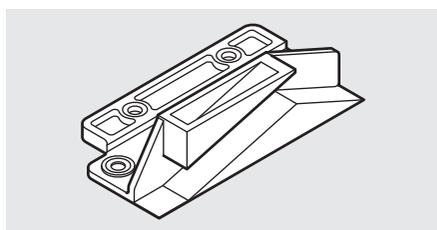
Для центрального запираения ящиков. В комбинации с запорными системами. Если один ящик открыт, остальные запираются (блокировка открывания).
