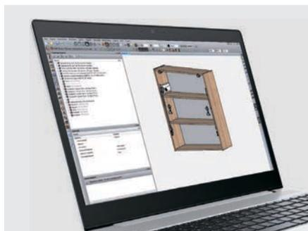
В библиотеку интегрированы 3D модели подъемных механизмов, петель, направляющих, выдвигающих ящиков и внутренней организации для них. Все модели содержат присадочные размеры согласно техническому руководству по установке фурнитуры Blum.
